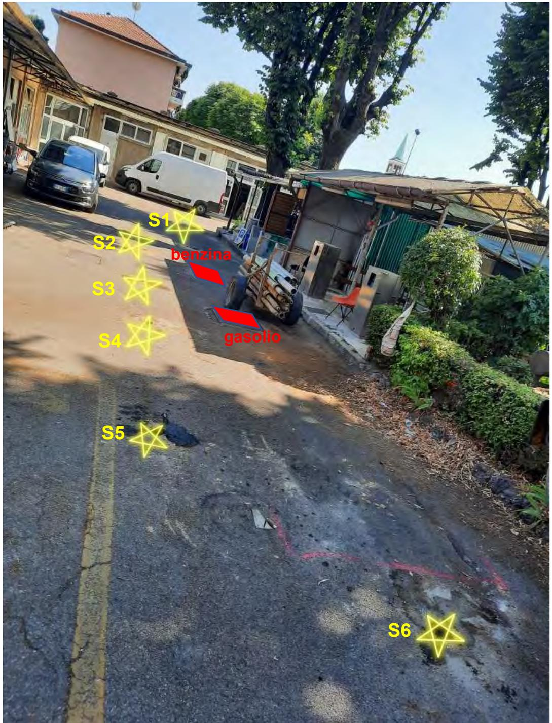
Foto 5 – posizione n. 6 sondaggi eseguiti attorno ai serbatoi (in rosso i tombini imbocco serbatoi)
